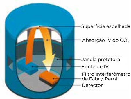
Figura 2. A estrutura do sensor de CO 2 CARBOCAP® da Vaisala.
