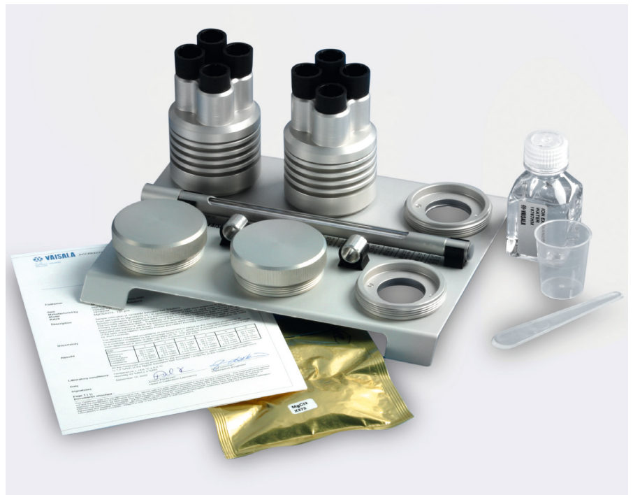
Vaisalan HMK15-kosteuskalibraattori monen pisteen kenttäkalibrointia varten.
