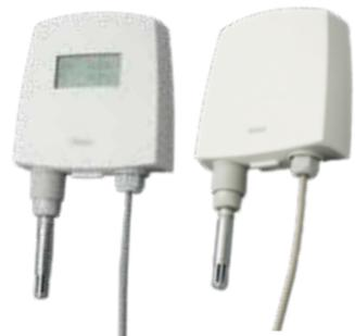
Genauigkeit  $\pm 1,5\%rF$ ,  $\pm 0,1\text{ }^\circ\text{C}$
