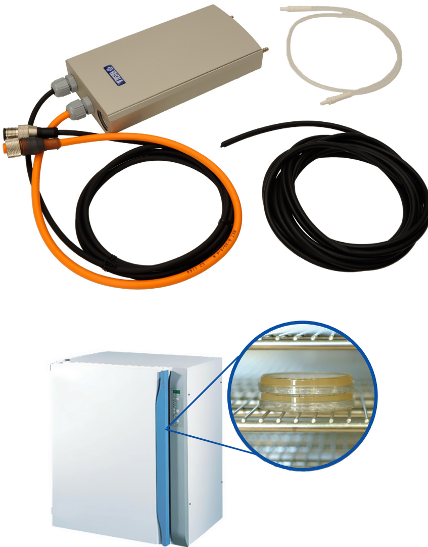
Vaisala GM70:ää käytetään inkubaattorien hiilidioksiditason tarkistamiseen.
