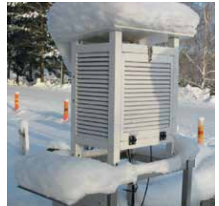
Kuva 2: Kaksi HUMICAP®-mittalaitetta asennettiin suojakaappiin Vaisalan testialueella Vantaalla. Myös anturien puhdistustoimintoa käytettiin.
