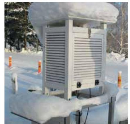
Abbildung 2: Zwei HUMICAP®-Instrumente wurden im Innern eines Stevenson Screen auf dem Vaisala Testgelände in Vantaa, Finnland angebracht. Auch die Sensorreinigung wurde angewendet.
