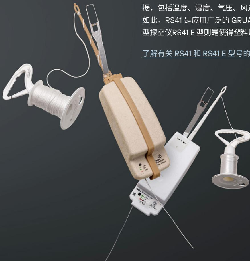
维萨拉自动探空系统AS41 可与 RS41 和 RS41 E 无线电探空仪无缝配合，即使在恶劣的环境和偏远的地方也能提供全天候探空数据。
