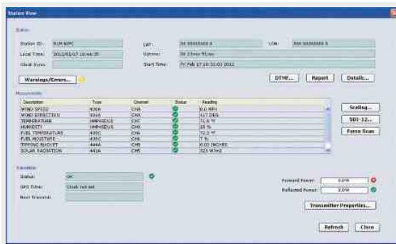
La fenêtre « StationView client AWS » de Vaisala affiche des informations de base sur la station, les capteurs et le transmetteur de données GOES. Grâce à StationView, les utilisateurs GOES peuvent modifier facilement les affectations NESDIS, exécuter les diagnostics, transmettre un message d'essai et calculer l'alignement de l'antenne.
