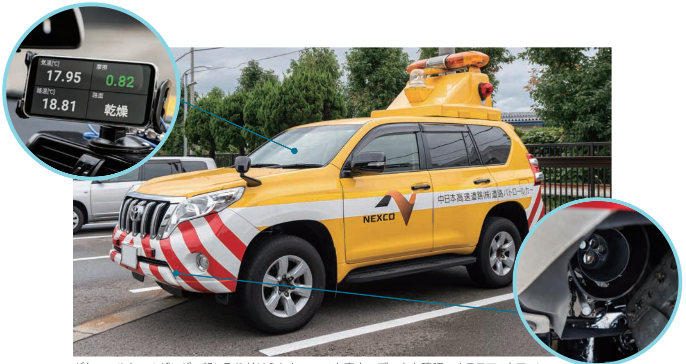
パトロールカーのバンパー部に取り付けられたMD30と車内でデータを確認できるスマートフォン
