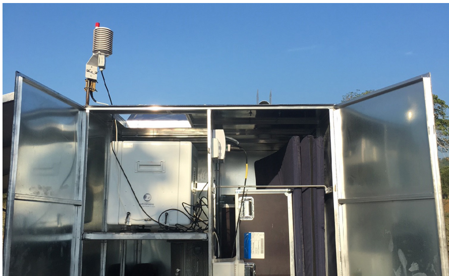
WindCube instalado dentro de un remolque diseñado por Ventus
