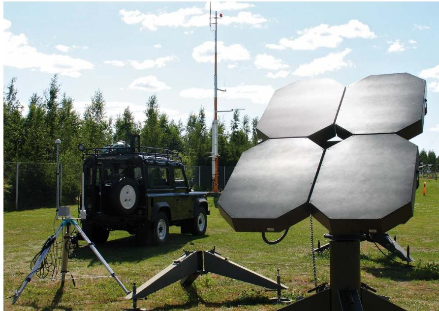
*Le radiothéodolite Vaisala RT20A est l'antenne tous temps, dure à la tâche, pour l'acquisition automatisée des données météorologiques destinées au soutien de l'artillerie et des autres opérations tactiques.*
