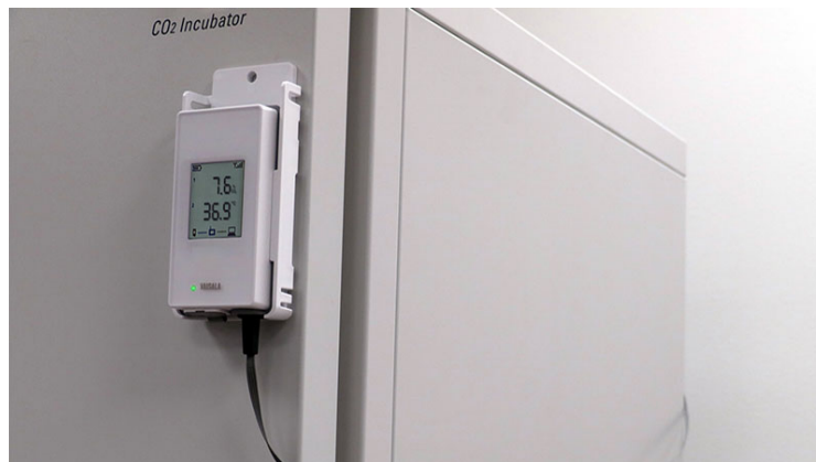
製品写真1. シンプルなインキュベータのモニタリングの運用 ヴァイサラのワイヤレス RFL100 データロガー
