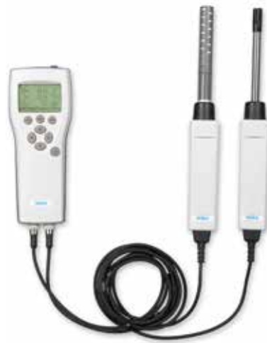
Transmetteur Indigo 200 avec sonde à dioxyde de carbone GMP251
