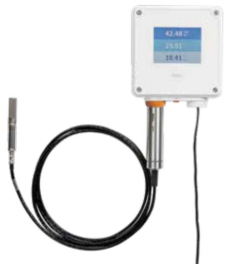
Sonde HUMICAP ® HMP7 avec transmetteur Indigo201
