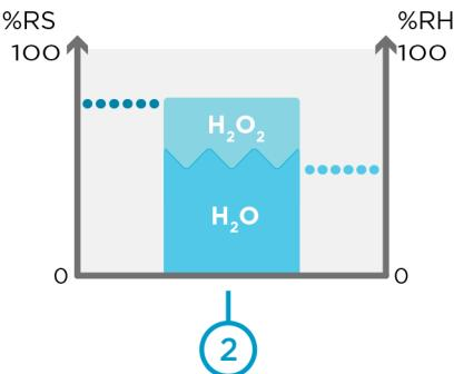
qui représente ces deux vapeurs. Il est donc essentiel de surveiller la valeur de saturation relative au cours d'un processus puisqu'elle indique le point de saturation des vapeurs combinées : l'eau et le peroxyde d'hydrogène.
