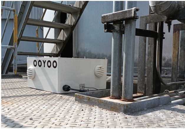
写真 7: 顧客サイトにて検証中の CO 2 計測・回収キット
