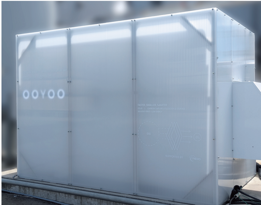
写真 2：2026 年、某火力発電所に設置された 100kg/日量の CO 2 回収装置
