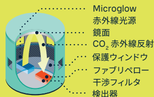
CARBOCAP の基本構造
