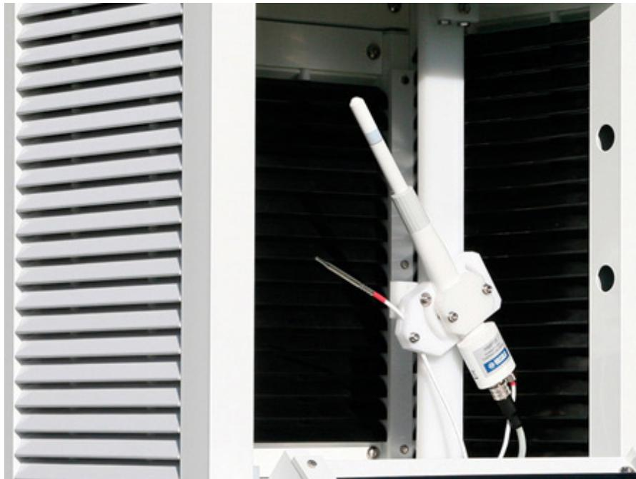
В климатических районах с высокой влажностью, близкой к насыщению, и в средах с меняющейся температурой, сбор точных данных особенно сложен. Именно для таких условий специально создан датчик температуры и влажности Vaisala HUMICAP® HMP155.
