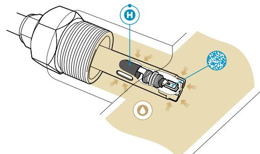
La progettazione esclusiva del trasmettitore MHT410 prevede il posizionamento dei sensori di idrogeno e umidità direttamente nel flusso del liquido isolante, assicurando il massimo livello di precisione e affidabilità delle misurazioni.
