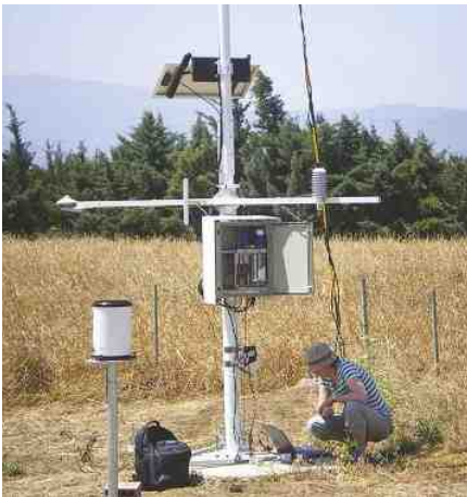
维萨拉WXT520天气变送器 - 一台仪器实现6种不同气象参数的测量
