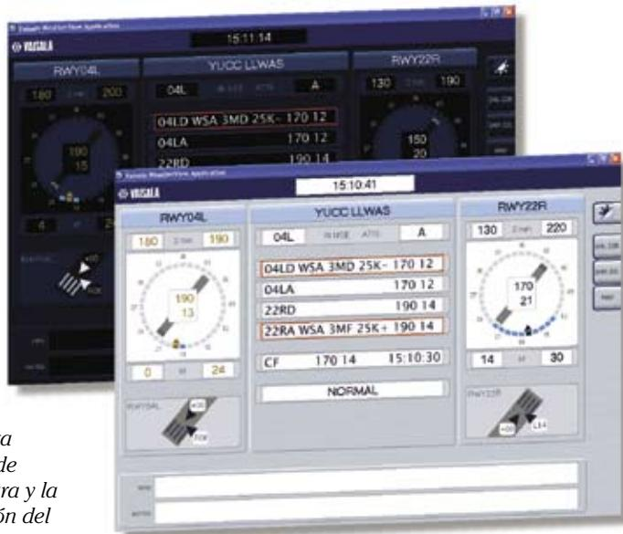
*La pantalla de alerta muestra el umbral de alertas de cizalladura y la velocidad y dirección del viento. También muestra la velocidad y dirección del viento en el centro del campo y el estado del sistema.*
