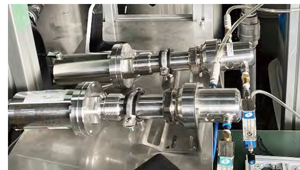
日本特殊陶業社 実証試験中のCO 2 回収装置 および装置内のマルチガスプローブMGP261
