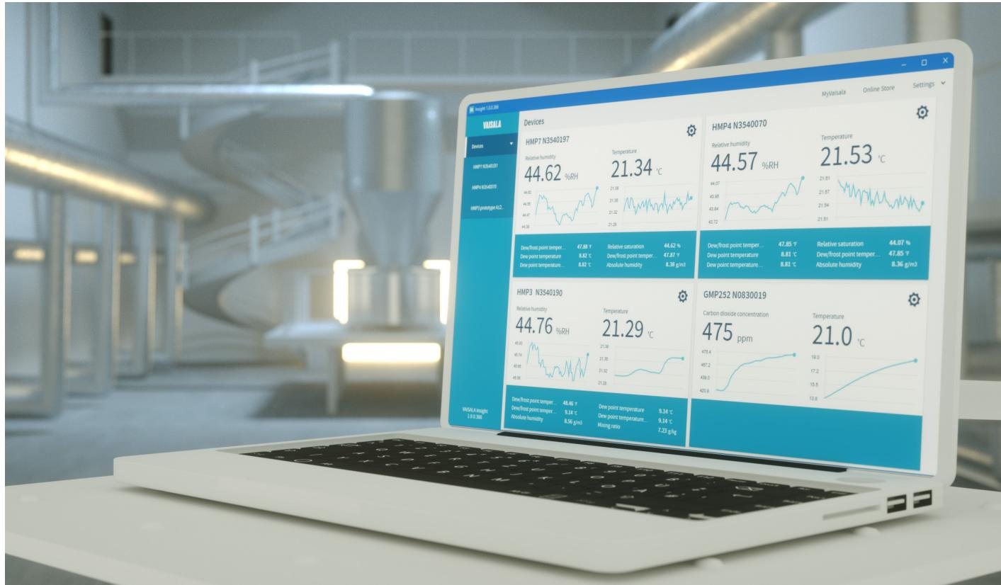
通过维萨拉 Insight 电脑软件，可以快速访问 Indigo 兼容探头的配置选项和校准数据。可以将探头从生产过程测量连线状态中分离出来，并通过 USB 电缆连接到电脑以访问 Insight 电脑软件。该软件具有直观的图形用户界面，还允许对探头区域进行校准和调整。通过它还可以轻松进行测试和评估 – 借助 48 小时的数据记录功能，可以同时从多达六台设备记录数据，并轻松导出为 Excel 可读格式。
