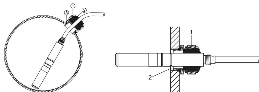
**HMP247CG**: Installazione a tenuta di vapore con pressacavi.
