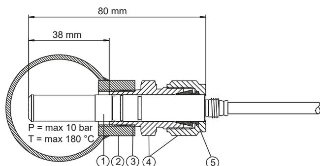
Kit di installazione Swagelok di tenuta a pressione **SWG12ISO38** con filettatura ISO3/8" o **SWG12NPT12** NPT1/2" (SWG6ISO18 con filettatura ISO1/8" o SWG6NPT18 con filettatura NPT1/8" per la sonda di temperatura HMT337).
