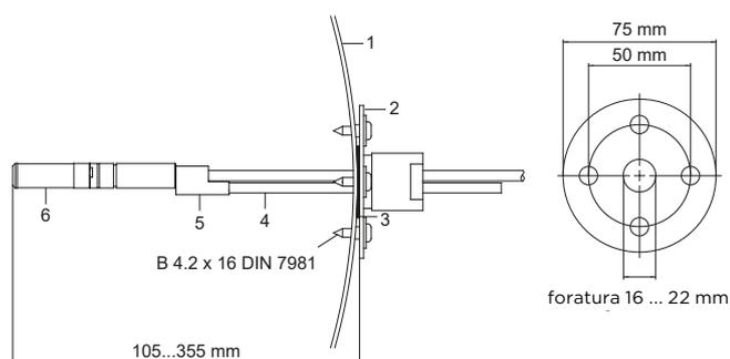
Kit di installazione condotti **10697** (215003 per sonda temperatura HMT337).
