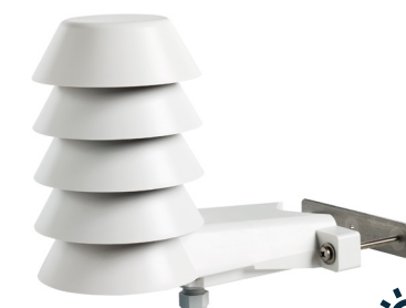
HMS110 실외 습도 및 온도 트랜스미터 정확도 \pm 2\% RH, \pm 0.2 °C 출력: 4-20 mA, Modbus RTU 통합 강우 및 차광통 강한 바람과 결빙 조건을 견딜 수 있음
