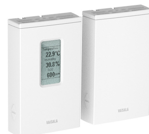
GMW90R 이산화탄소, 온습도 송신기 정확도 \pm 1.7\% RH, \pm 0.2 °C 출력: 4-20 mA, 0-10 V, Modbus RTU 교환 가능한 측정 모듈 슬라이딩 커버가 있는 디스플레이
