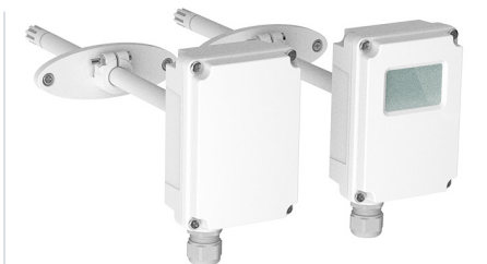
TMD110 덕트 온도 트랜스미터 정확도 \pm 0.2 °C 출력: 4-20 mA, Modbus RTU IP65 합체, 디스플레이[선택 사항] 내구성 있는 디자인, 간편한 설치
