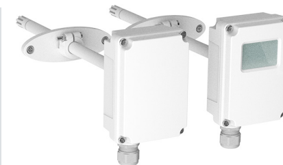
HMD110 덕트용 습도 및 온도 트랜스미터 정확도 \pm 2\% RH, \pm 0.2 °C 출력: 4-20 mA, Modbus RTU IP65 합체, 디스플레이[선택 사항] 내구성 있는 디자인, 간편한 설치
