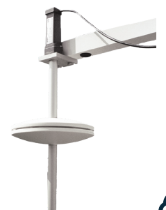
PTB210 + SPH20 Baromètre numérique + têtes de pression statiques
