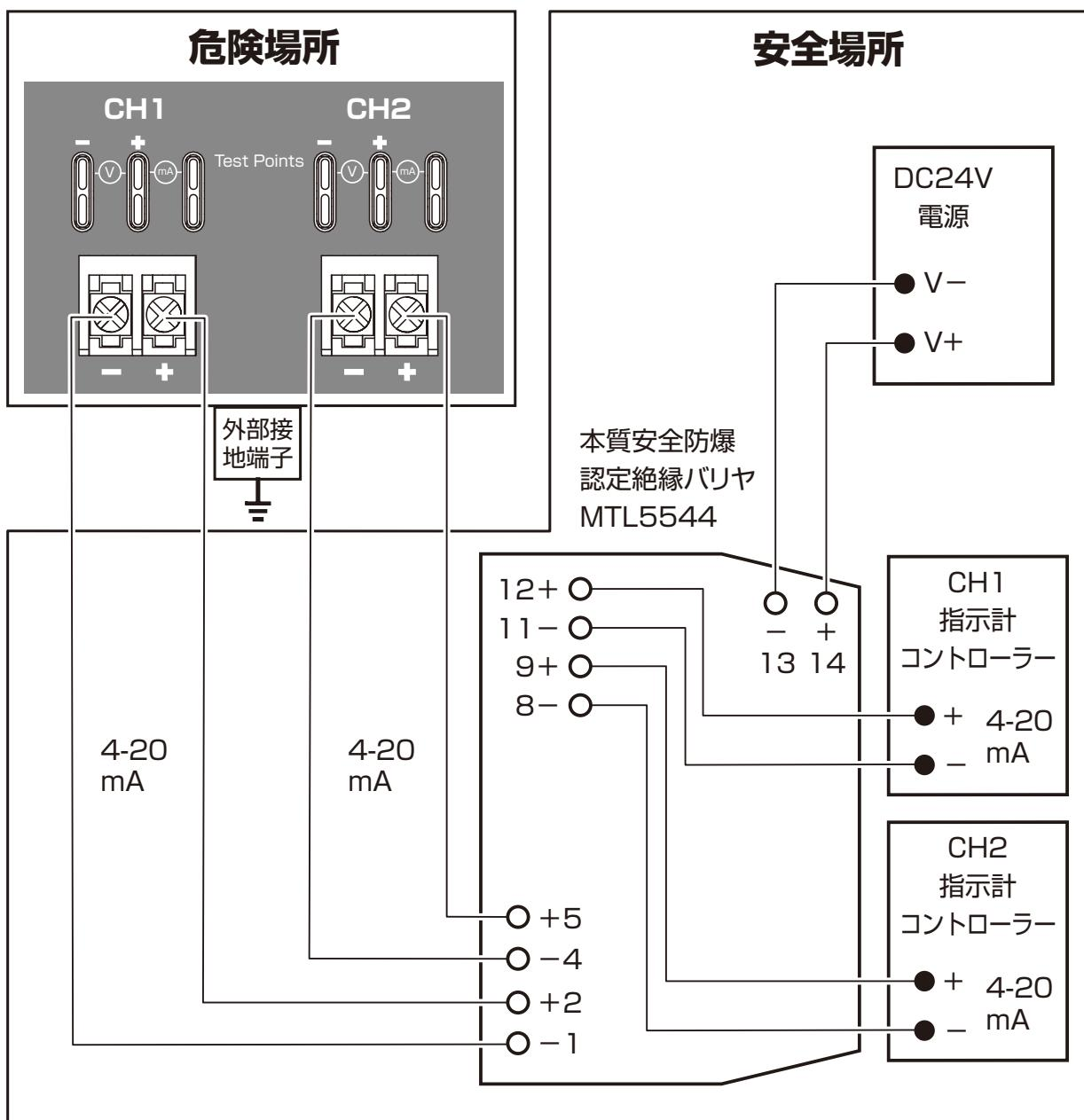
コントローラーが電圧入力を使用する場合は、シャント抵抗を使用してください。
