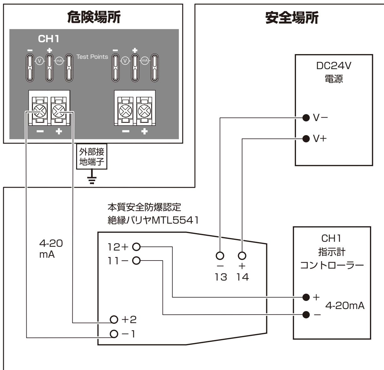
コントローラーが電圧入力を使用する場合は、シャント抵抗を使用してください。
