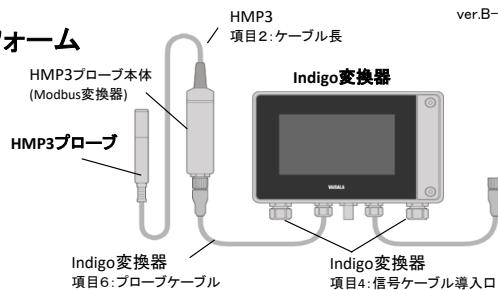
AC電源、アナログ4Ch出力、リレー出力、気圧モジュールの追加にはIndigo520が必要です
