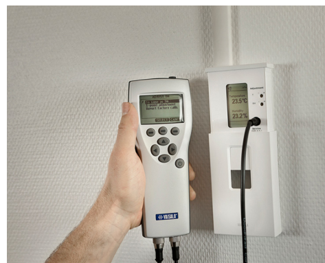
Étalonnage sur site grâce à l'indicateur portable de mesure HM70
