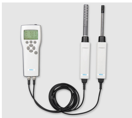
MI70の2つのポートにより、CO 2 とRH/T a を同時に計測可能
