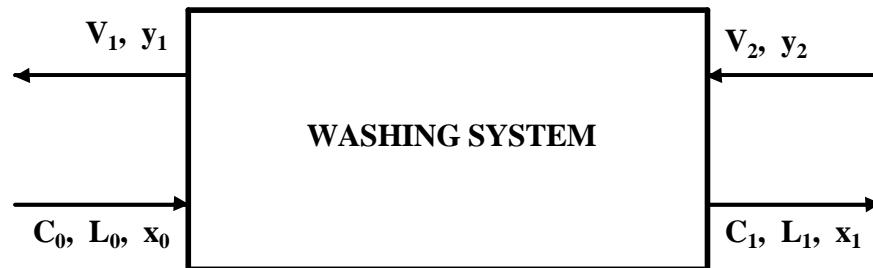
$$L_0 + V_2 = L_1 + V_1$$
