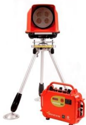
Wind Iris (四光束) 增加了垂直风场的测量
