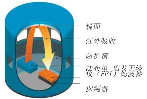
图2. 维萨拉CARBOCAP CO 2 传感器的结构
