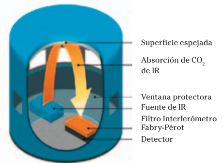
Figura 2. Estructura del sensor de CO 2 CARBOCAP de Vaisala.
