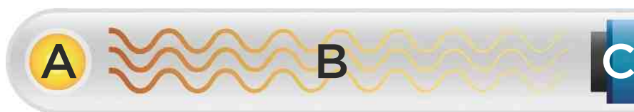
Abb. 1. Die Infrarotabsorption von CO 2 -Molekülen kann mittels eines Infrarotsensors gemessen werden.
