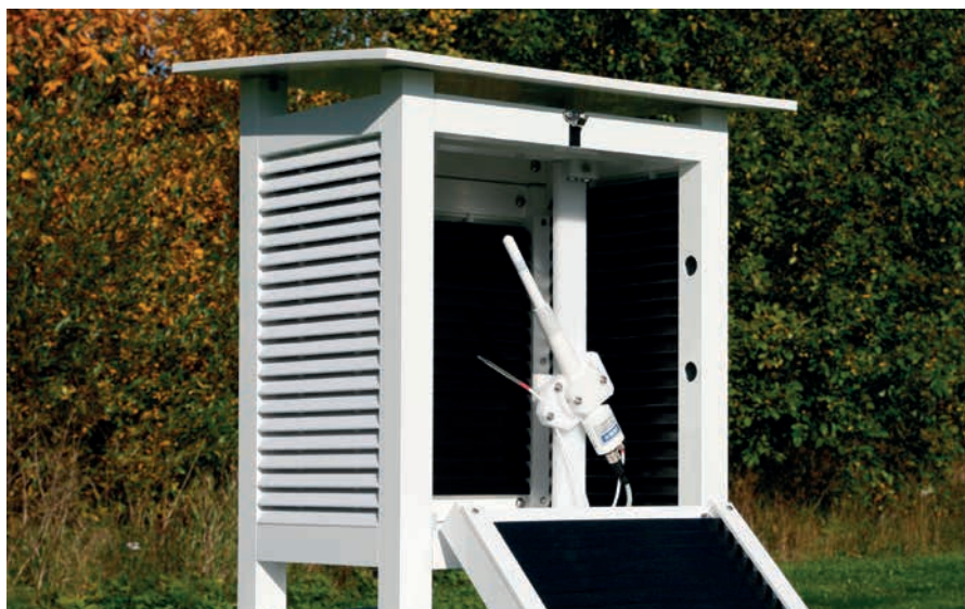
HMP155本体とオプションの温度プローブと百葉箱への取り付けキット
