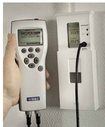
Calibração no local do transmissor de umidade HMW90 com o medidor portátil HM70.
