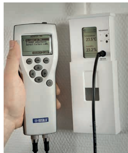
HM70 ハンディタイプを使用したHMW90湿度変換器の現場校正
