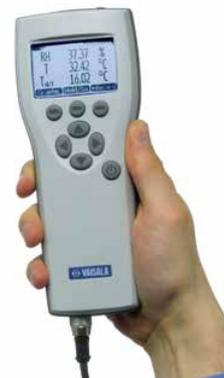
*Medidor manual de umidade no óleo HUMICAP® MM70 da Vaisala foi projetado para a verificação em campo dos transmissores MMT330.*
