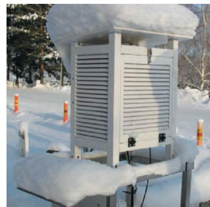
図2: センサーパージを使用したHUMICAP®装置を2個取り付け付けたフィンランド・ヴァンターに設置されたヴァイサラ試験場のスティーブソン式百葉箱
