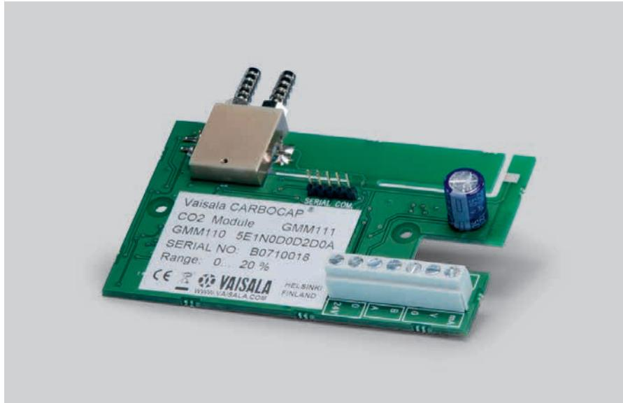
ヴァイサラCARBOCAP® GMM111 CO<sub>2</sub>モジュールは、フロースルーによるCO<sub>2</sub>計測モジュールです。
