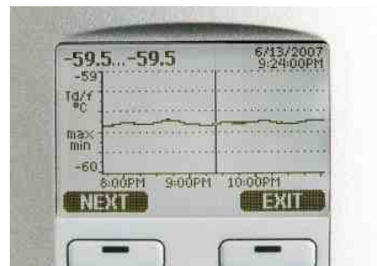
显示屏可显示测量曲线、实时数据以及历史数据。
