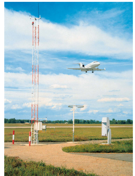
Der PWD22 wird für automatische Systeme zur Wetterbeobachtung (AWOS) empfohlen.
