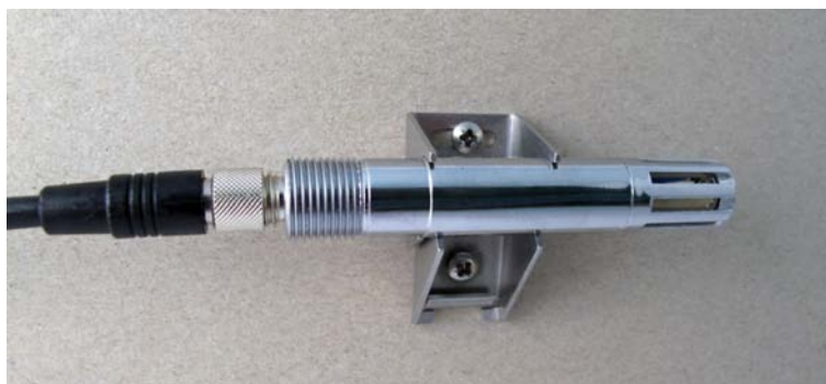
Рис. 3 Крепежный зажим датчика после установки
