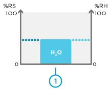
H。O。蒸気による除染プロセス中は、過酸 化水素蒸気に加えて必ず水蒸気が存在し ます。凝縮を制御するためには、水蒸気に よる空気の湿度と過酸化水素蒸気による 空気の湿度の両方を把握する必要があり ます。相対水分飽和度は、空気中の過酸 化水素蒸気と水蒸気の凝縮を示し、両方 の蒸気を表す"唯一"の値です。つまり、 相対水分飽和度は水蒸気と過酸化水素 蒸気で構成された混合蒸気の飽和点を示 すため、プロセス中に相対水分飽和度を モニタリングすることが重要といえるの です。
