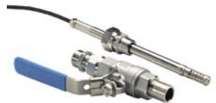
MMT338 探头安装在压力管线中。在工艺过程不停机的情况下，探头就可以拔出或插入，且插入的深度可以调节。
