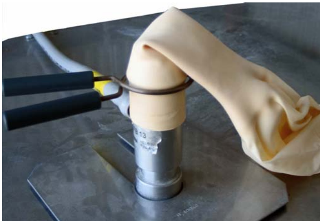
Figure 3 Fixation du ballon sur la buse à gaz
