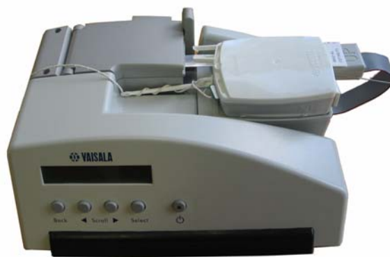
Figure 14 Radiosonde du GC25 avec câble de communication raccordé
