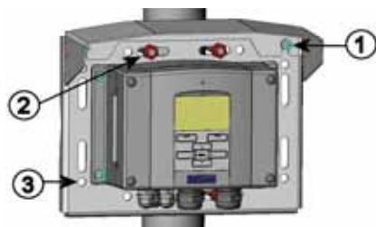
図 12 取り付けキット使用のレインシールド取り付け
