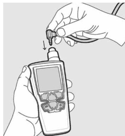
Mätprobens kontakt del ansluts till indikator HM40 för avläsning av mätresultat.
