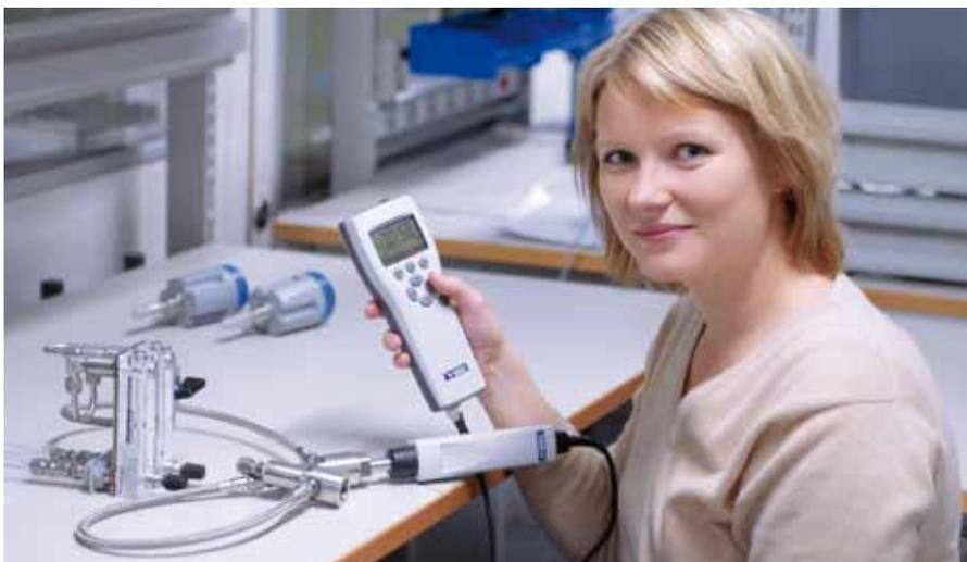
Mit den **portablen Messgeräten DM70** können Sie Taupunkt und Temperatur über einen weiten Messbereich genau messen. Die Sonde kann direkt in Druckprozesse bis zu 20 bar (290 psi) eingeführt werden und hat kurze Ansprechzeiten unter Umgebungs- und Prozessbedingungen.
